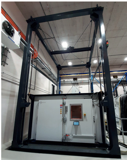
Der 350-Kilonewton-Shaker mit Klima- haube ermöglicht kombinierte mechani- sche und elektrische Tests mit Umge- bungsbedingungen von -40 bis +100 Grad Celsius. © Weiss Umwelttechnik GmbH
